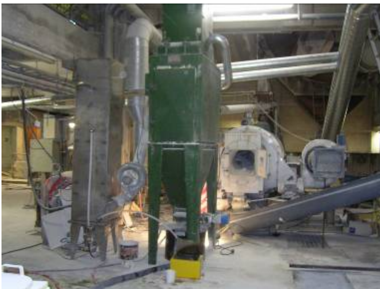
Bild 1: till vänster skrubber för tillverkning av fuktmetad luft, mitt i bild frånluftsiltret (grönt), bakom till höger skymtar släckarens utmatningsände.
