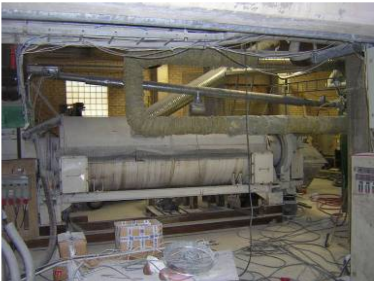
Bild 4: Släckarens tubulär med kalkinmatning till vänster, utmatningsände till höger.
