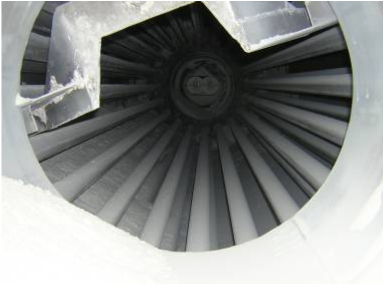
Bild 10: De långsgående tuberna som syns inne i släckaren utgör, tillsammans med tubulärens mantelyta, kyl- eller värmeytor beroende på tillämpning. Ytorna är rena från beläggningar och endast en mindre mängd material finns inne i släckaren.
