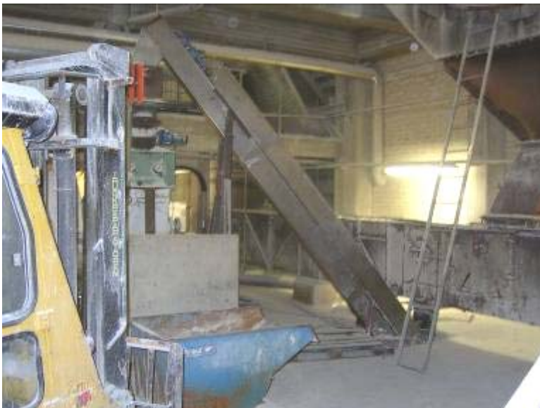
Bild 7: Elevator som hämtade bränd kalk från mesaugnens redlertransportör eller från silo med truck.
