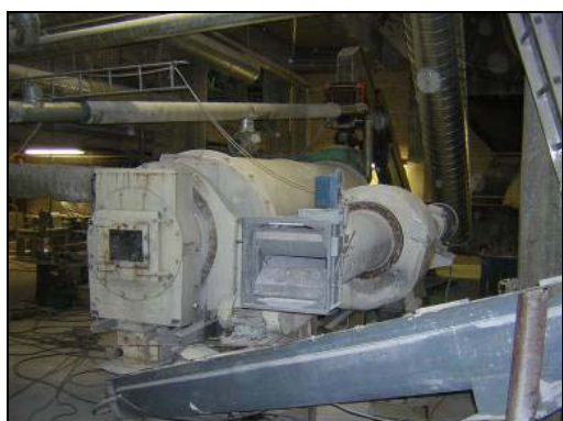
Bild 3.3.1 Torkapparaters roterande tubulär som användes vid pilotförsök i Sandarne 2006
