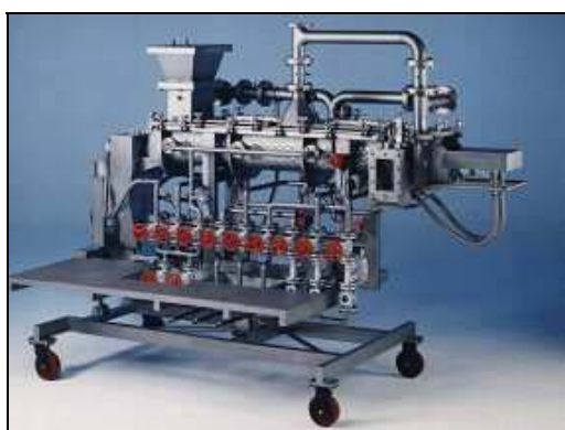
Bild 3.2.3 Paddle Dryer, mobil labtestutrustning från GMF Gouda.
